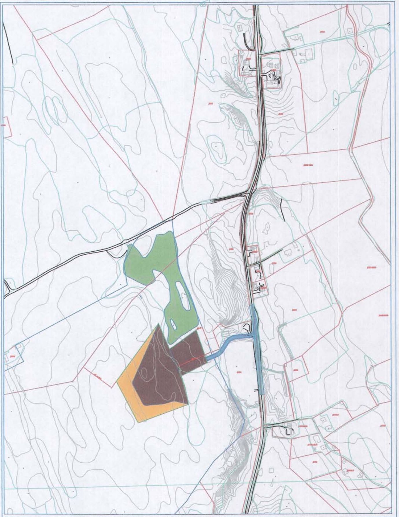
Plan i M = 1 : 5000 – Brunt viser bunnen i avsluttet uttak - Gult viser ferdig skråning.
